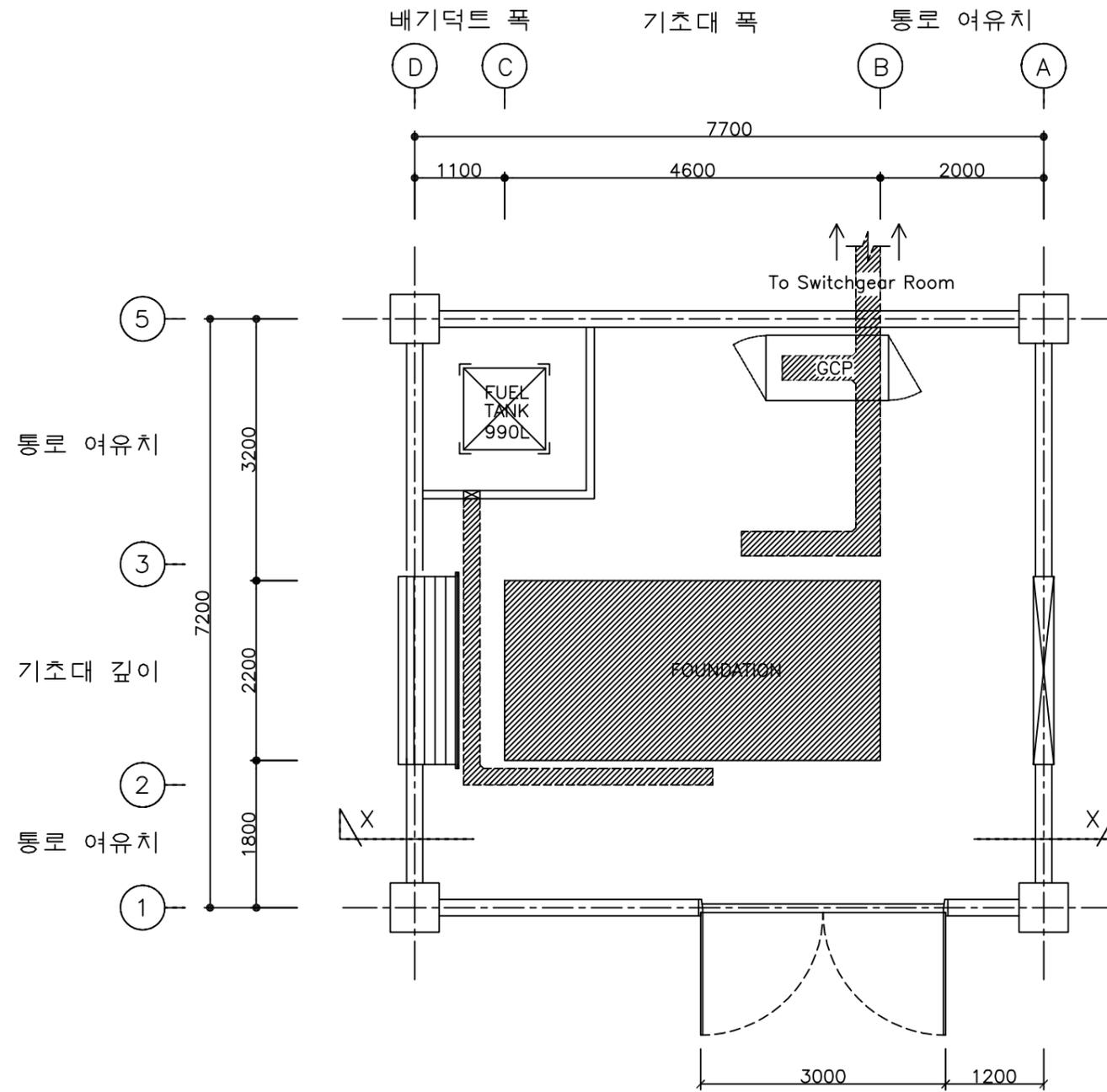
① 발전기실 FOUNDATION, TRENCH 설비 평면도
